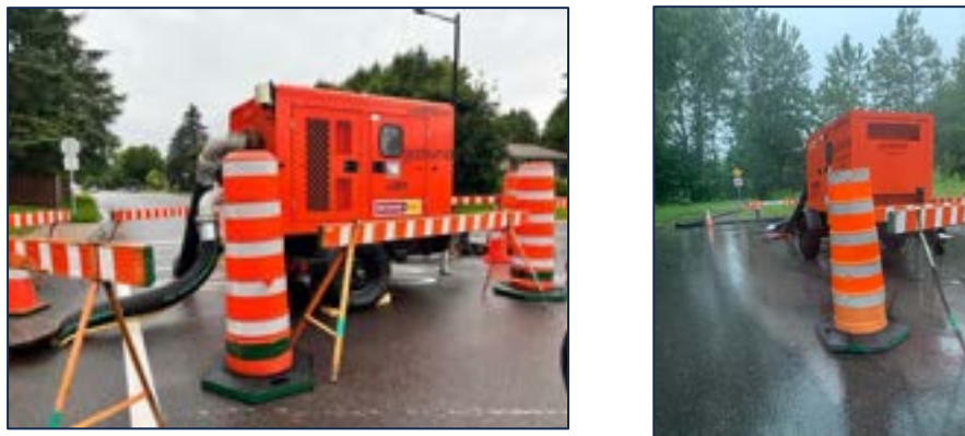
Figure 62 : Pompes d'appoint déployées par la Ville de Québec lors des épisodes de débordement de l'été 2023.
