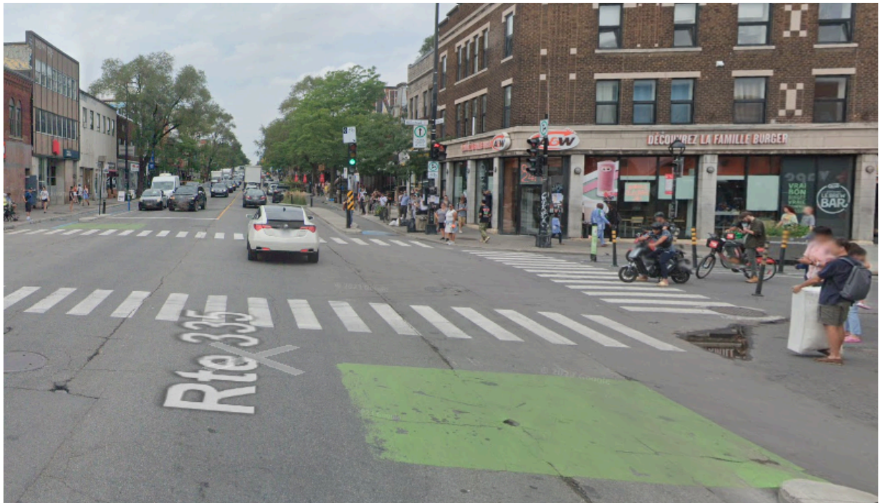
Figure 3-A : Les feux avec phase piétonne, cycliste et voiture concourantes commencent avec une phase où les piétons et les vélos peuvent circuler dans l'axe (feux piétons et cyclistes séparés à droite de la photo) et les conducteurs de voiture doivent circuler tout droit ou attendre pour le droit de virage (feu en flèche verte indiquant les mouvements permis et prioritaires)
