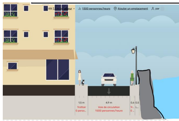
Figure 2: Rue des Remparts EXISTANT
